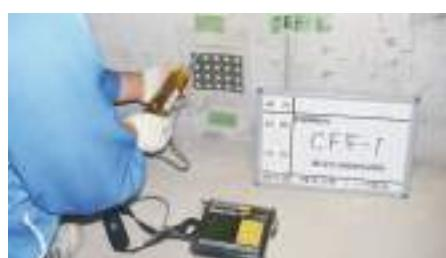
コンクリート表面を打撃したときの反発力を利用したコンクリート部材の調査装置です。非破壊による圧縮強度の推定や均質性の測定に用います。精度の高い圧縮強度の調査には、コア供試体抜き取り試験法を採用します。
