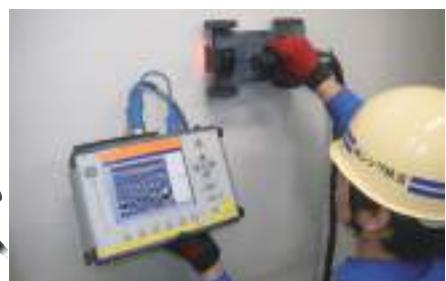
アンテナを換える事により80cm程度のコンクリート厚さ測定や高深度下の鉄筋探査が可能です。(トンネル支保工 等)
