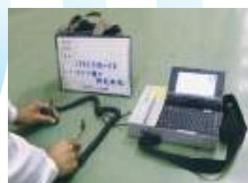
衝撃弾性波の伝播速度や反射時間などを利用した非破壊によるコンクリート部材の調査装置です。圧縮強度の推定からひび割れ深さの測定、板状構造物の厚さ検知、剥離、空洞など内部欠陥の探査などができます。
